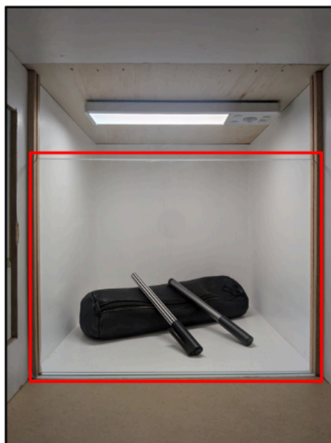
Abbildung 2.4: Innenansicht mit eingesteckter transparenter Scheibe (rot markiert)
